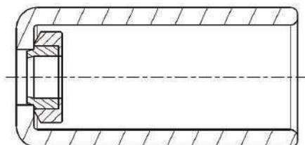
Composé d'une bague, d'un joint et d'un capuchon, le racleur permet de nettoyer efficacement la tige du vérin de la plupart des saletés, afin d'en augmenter la durée de vie. La matière du racleur est composé d'Alu/NBR/PVC.
