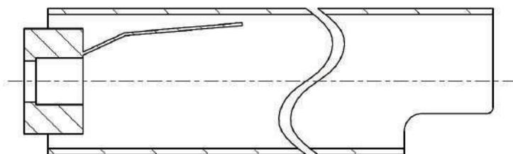
Nos tubes de blocage assurent le verrouillage du vérin à gaz en position ouverte. Cela permet de sécuriser un ouvrant muni de ressort à gaz lorsque des personnes sont ammenées à rester en dessous. Le déblocage se fait par une simple pression sur le tube. 1 seul tube de blocage par ouvrant est suffisant. Il est à noter que cela entrainera une réduction de course d'environ 20mm.
