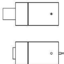
Cet outil de dégonflage est utilisé pour adapter la force d'un ressort à gaz à valve à l'application par petites pressions successives sur le bouton poussoir.
