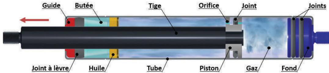
Également appelé Ressort à gaz de compression, le piston est poussé vers l'avant sous l'effet de l'azote sous pression contenue dans le vérin à gaz. Il est conçu pour pousser et réguler la vitesse de sortie de tige.
